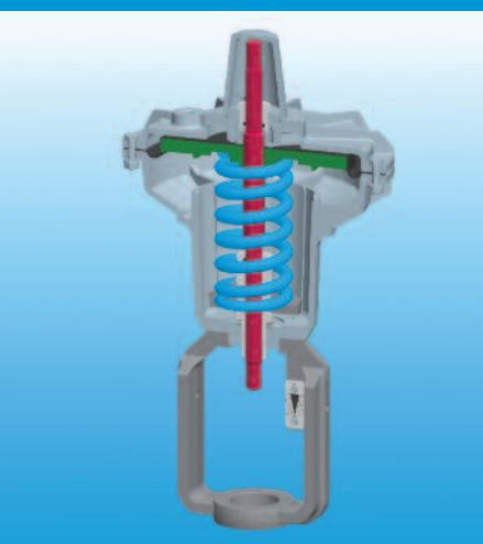
Универсальные мембранные приводы, Тип UMA 811, – линейка приводов, включающая четыре размера. Шток отличается двусторонней конструкцией, причем обе конфигурации для соединения с арматурой одинаковые, что упрощает переключение с одного направления на другое. Контрольно-измерительная аппаратура может устанавливаться в соответствии с требованиями стандартов NAMUR. Возможна установка узла ручного управления в случае возникновения аварийных ситуаций.
